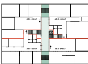
Brandschutz / Rettungswege I Maßstab 1:500. Mittels Brandschutz Türen werden die Nutzungseinheiten im Brandfall geschlossen
