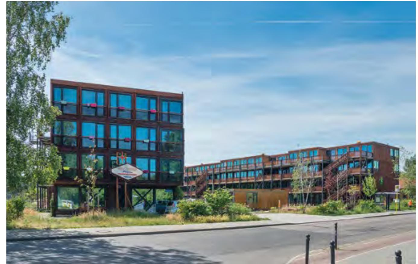
Schick und beständig: Die Außenfläche besteht aus wetterfestem Corten-Stahltrapezblech.
